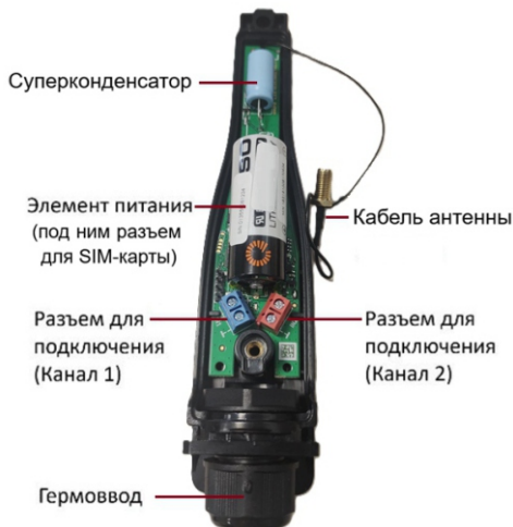
Рисунок 1 - Основные элементы радиомодема
